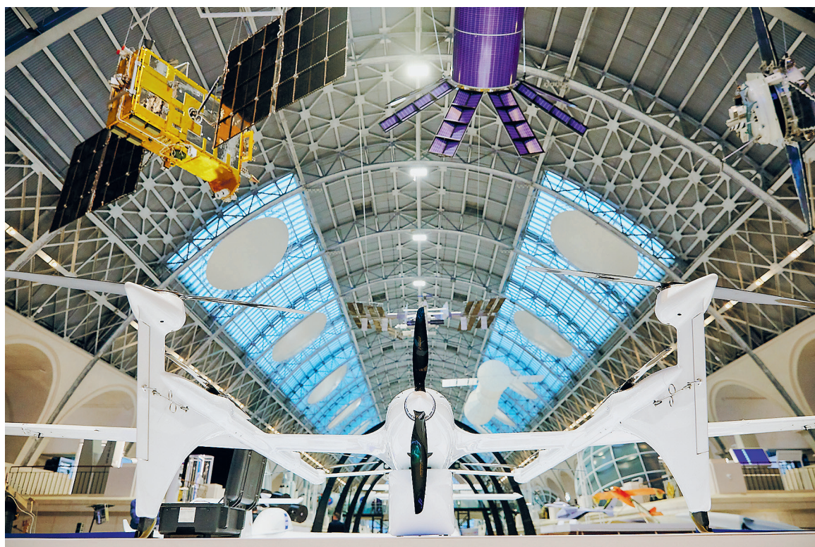
Конвертоплан Д-20К производства российской компании «Аэромакс» совмещает в себе функциональные возможности самолета и вертолета: аппарат может осуществлять дальние перелеты на большой скорости и способен к вертикальному взлету и посадке / АРТЕМ ГАНЖА
